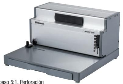
Encuadernadora de espiral metálico paso 5:1. Perforación eléctrica mediante pedal de hasta 20 hojas A4 de 80g. Encuaderna hasta 450 hojas A4 de 80g. con un espiral de 50 mm. Rodillo insertador eléctrico de la espiral. Regulación del margen lateral y de profundidad. Selector de diámetro de la espiral. Incluye alicates para cortar y doblar el espiral. 2 años de garantía.
